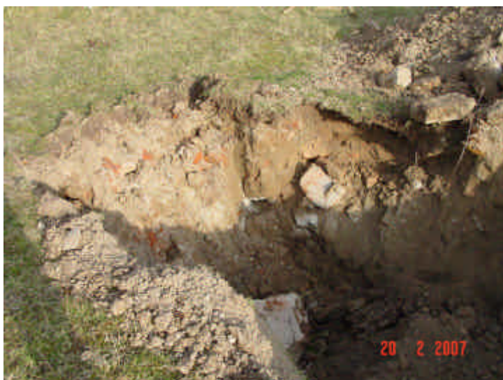
Bild 6: Voruntersuchung F58 Erkundungsschurf Auffüllung mit Boden- Bauschuttgemisch
