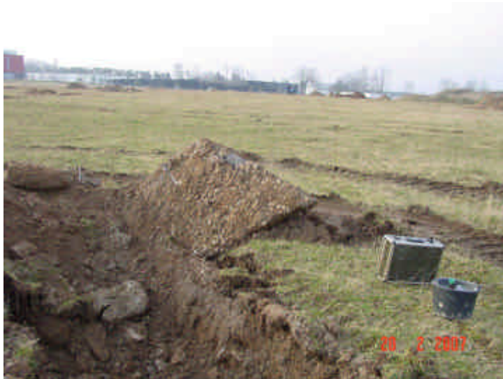
Bild 7: Voruntersuchung F58 Süd/Ost Schurffeld mit ausgehobenem Boden-/Bauschutt- /Schwarzdeckenmaterial
