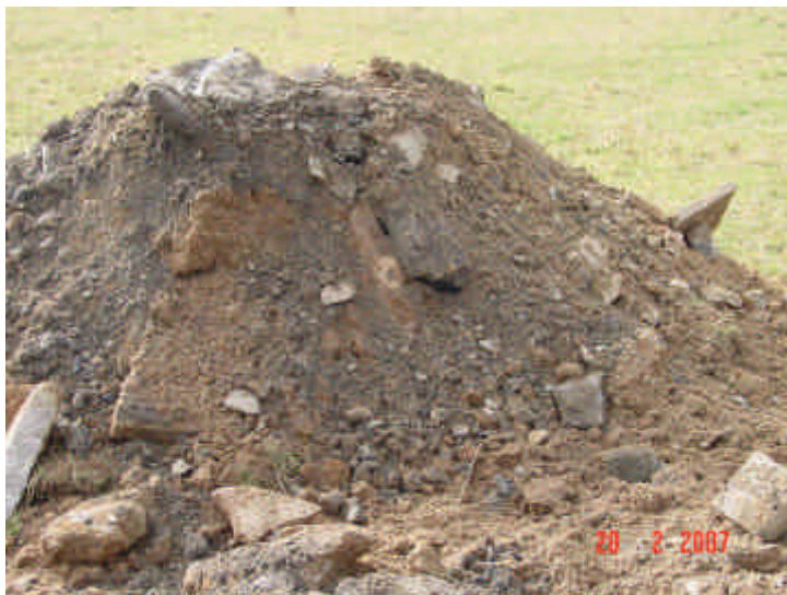
Bild 5: Voruntersuchung F58 Erkundungsschurf ausgehobenes Bodenmaterial mit Bauschutt-, Schotter- und Schwarzdeckenanteilen
