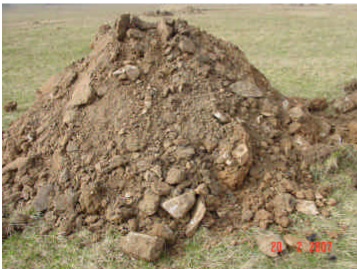
Bild 2: Voruntersuchung F58 Erkundungsschurf ausgehobenes Bodenmaterial mit Bauschutt-, Schotter- und Schwarzdeckenanteilen
