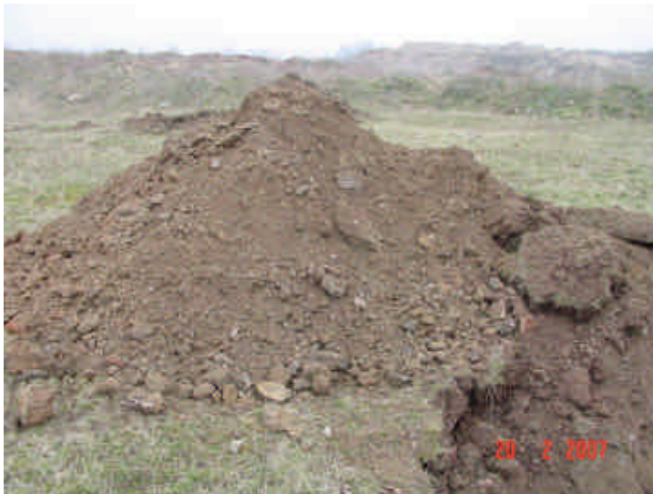
Bild 2: Voruntersuchung F58 Erkundungsschurf ausgehobenes Bodenmaterial mit Bauschutt- und Schwarzdeckenanteilen
