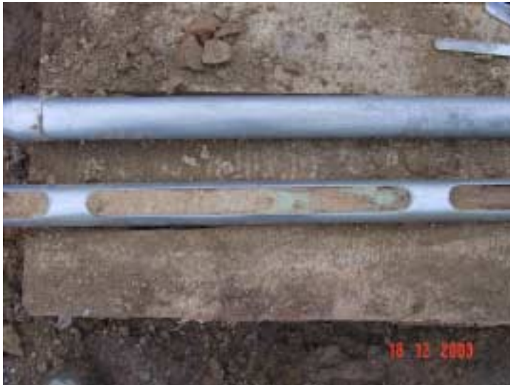
Bild 5: Bohrprofil: sandig - schluffiges Material mit überwiegend braunen Farben, z.T. marmoriert und/oder gebleicht (hier mit einer eingeschalteten hellgraublauen schluffig - tonigen Lage) über rotbrauner und blaugrauer tonig - schluffiger Sperrschicht (nicht abgebildet)
