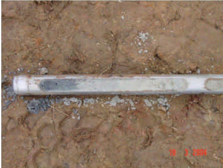
Bild 7: Bohrprofil: hellgraues, feinsandiges Material, z.T. mittelsandig unter tonig-schluffiger Sperrschicht (nicht abgebildet); im unteren Bereich (links) deutliche Kontamination (dunkle Verfärbung und aromatischer Geruch) (Untersuchungsphase: OU)
