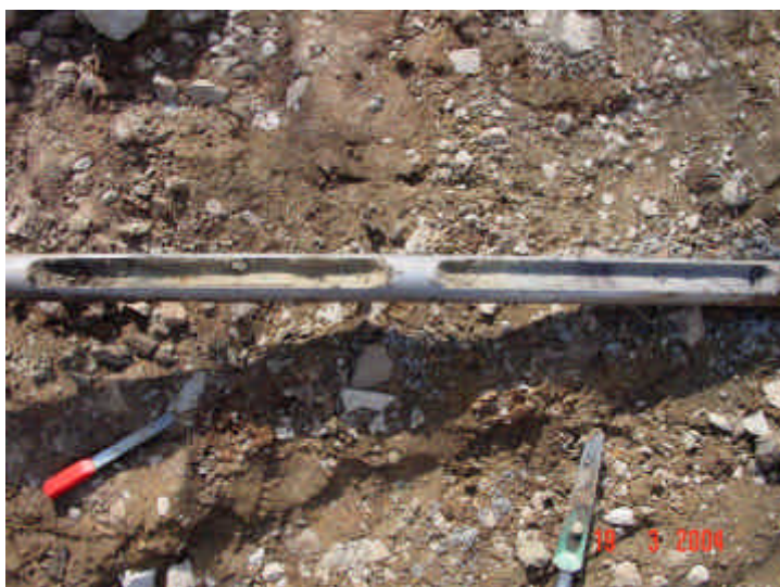
Bild 6: Bohrprofil: in den oberen 20 cm (links) rotbraune und blaugraue tonig-schluffige Sperrschicht; darunter überwiegend hellgrauer z.T. ockerfarbener Feinsand; im unteren halben Meter (rechts) einsetzende Kontamination (blaugraue Verfärbung und aromatischer Geruch) (Untersuchungsphase: OU)
