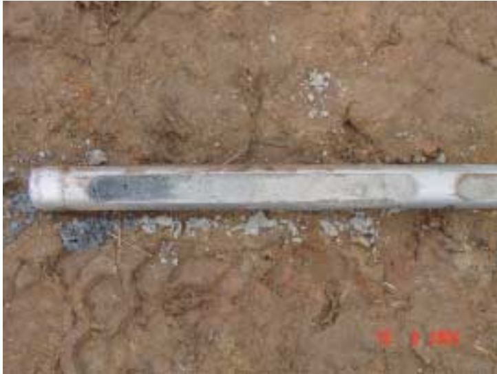
Bild 7: Bohrprofil: hellgraues, feinsandiges Material, z.T. mittelsandig unter tonig - schluffiger Sperrschicht (nicht abgebildet); im unteren Bereich (links) deutliche Kontamination (dunkle Verfärbung und aromatischer Geruch)
