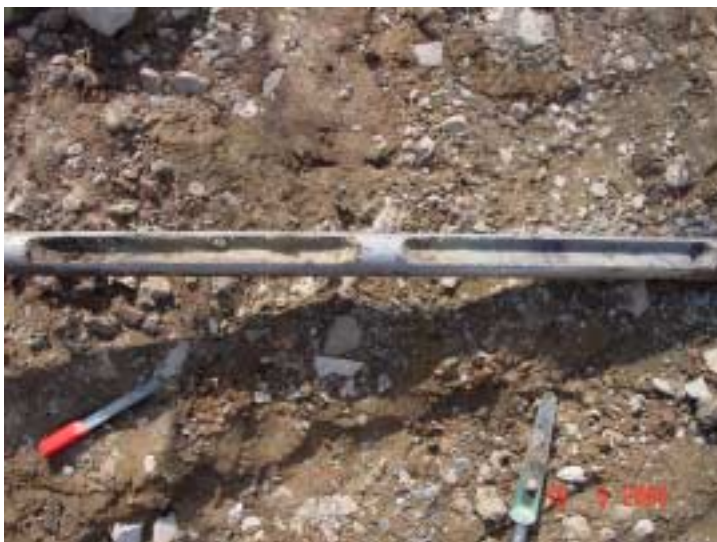
Bild 6: Bohrprofil: in den oberen 20 cm (links) rotbraune und blaugraue tonig - schluffige Sperrschicht; darunter überwiegend hellgrauer z.T. ockerfarbener Feinsand; im unteren halben Meter (rechts) einsetzende Kontamination (blaugraue Verfärbung und aromatischer Geruch)
