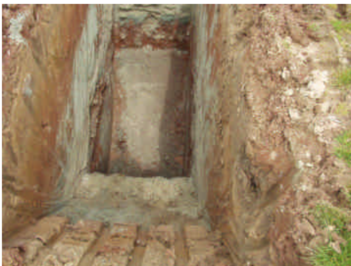
Bild 18: Typisches Bodenprofil mit braunen, marmorierten sandig-schluffigen Materialien unterlagert von einer rotbraunen und blaugrauen schluffigen Sperrschicht bei Schurf 6; liegend folgen hell- bis blaugraue (mittelsandige) Feinsande (Untersuchungsphase: DU)
