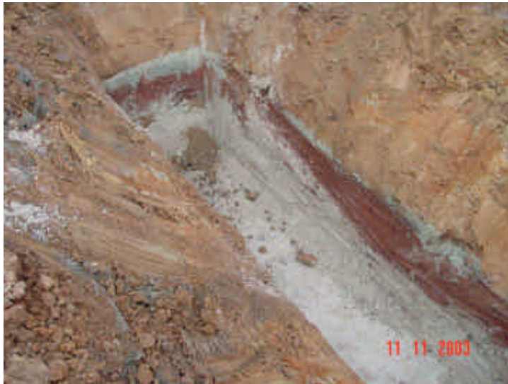
Bild 4: Typisches Bodenprofil: braune, marmorierte sandig-schluffige Materialien unterlagert von einer rotbraunen und blaugrauen schluffig-tonigen Sperrschicht; liegend folgen hell- bis blaugraue (mittelsandige) Feinsande (Untersuchungsphase: Erstuntersuchungen Kanalbau)
