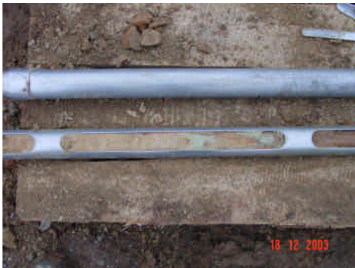
Bild 5: Bohrprofil: sandig - schluffiges Material mit überwiegend braunen Farben, z.T. marmoriert und/oder gebleicht (hier mit einer eingeschalteten hellgraublauen schluffig-tonigen Lage) über rotbrauner und blaugrauer tonig-schluffiger Sperrschicht (nicht abgebildet) (Untersuchungsphase: OU)
