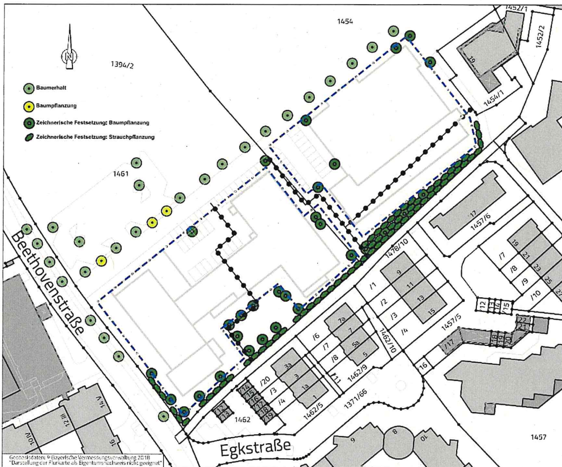
Abb. 4: Baumerhalt und Baumpflanzungen (Empfehlungen und zeichnerische Festsetzungen) Quelle: Geobasisdaten: © Bayerische Vermessungsverwaltung (www.geodaten.bayern.de)
