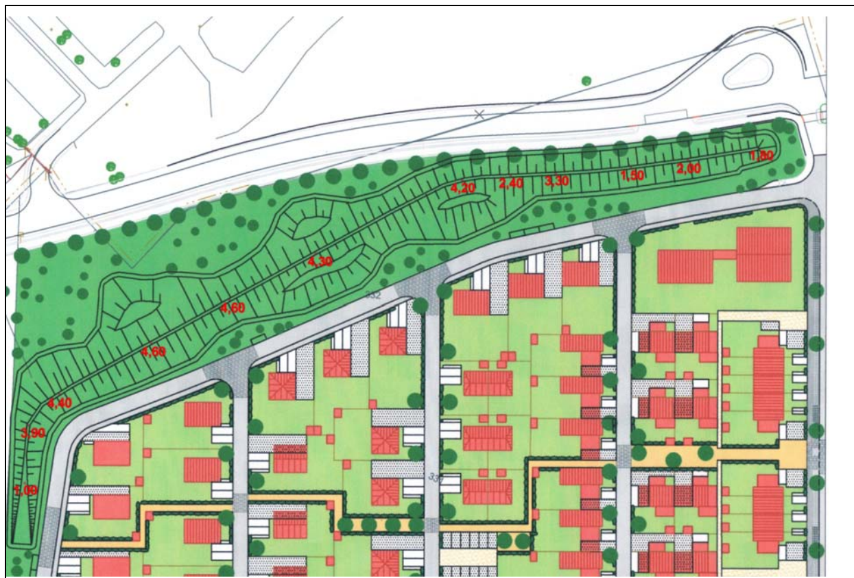
Lärmschutzwand im westlichen Bereich mit den absoluten Höhen über dem natürlichen Gelände
